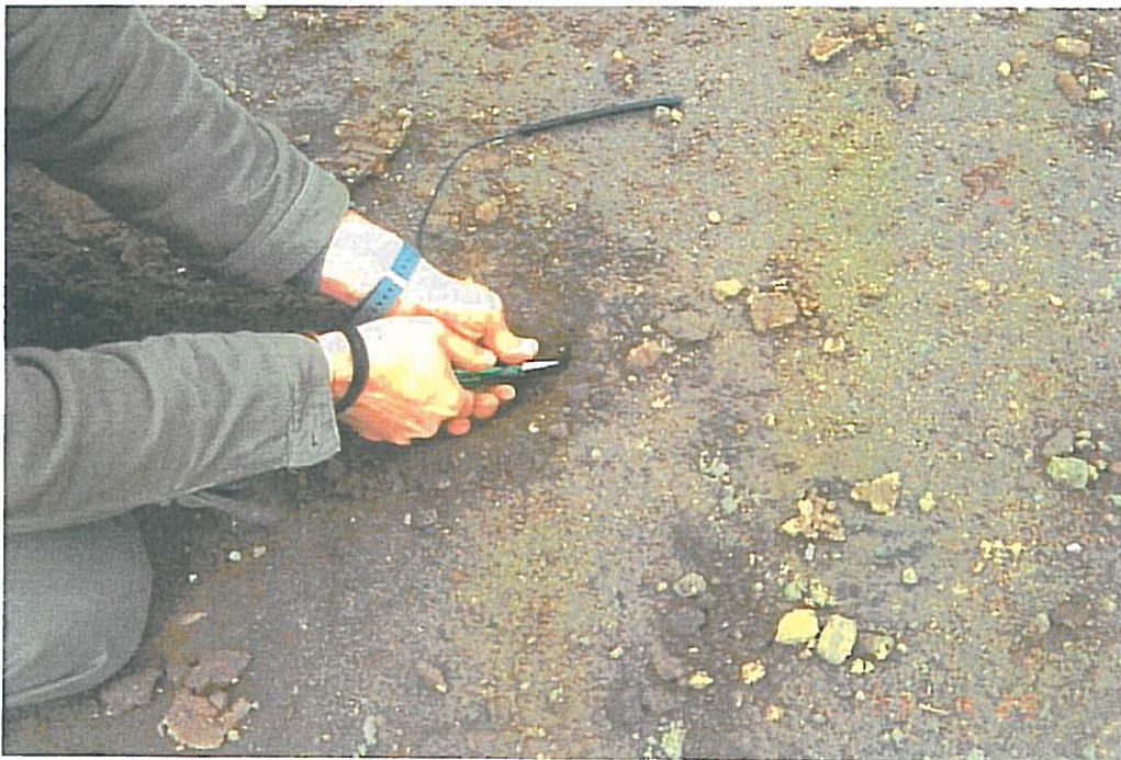
Bild 4: Eingraben eines Stabsensors in die Stützschiicht der KDB
