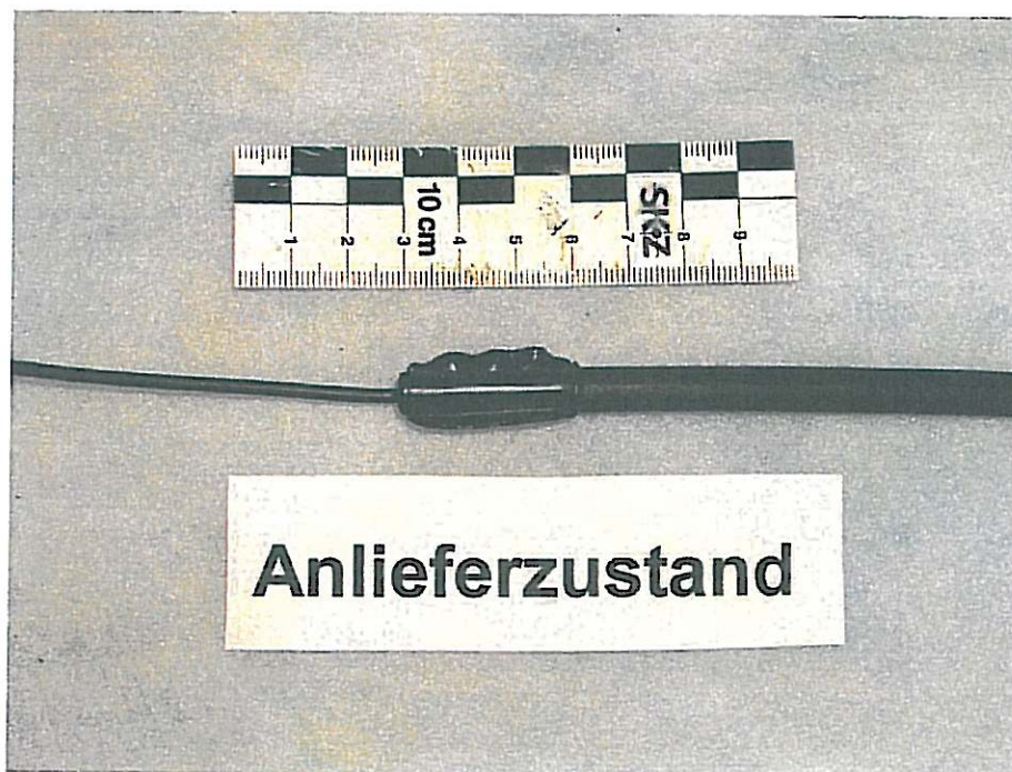
Bild 3: PE-Sensor mit eingeschweißtem PE-Kabel
