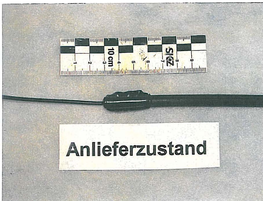
Bild 2: PE-Sensor mit eingeschweißtem PE-Kabel
